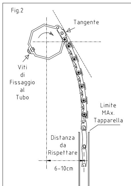
NOTA: Alzare la tapparella in modo di vedere l'ultimo elemento dall'interno con il gancio del Jolly Block come in Fig. 2-b. Inserire i due Grower ai due lati del gancio tramite una pinza in modo da dare riferimento ed impedire lo slittamento laterale.
